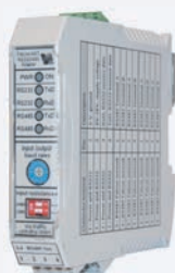
viafalcon NET Adapter: Für den Anschluss des viafalcon NET an den PC.
