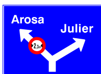
4.40 Vorwegweiser mit Anzeige von Beschränkungen
